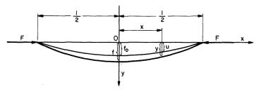
Fig. 5. Zentrisch belasteter Stab mit ursprünglicher Krümmung.
