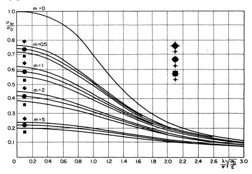
Fig. 4. Nomogramm zur Bestimmung der kritischen Spannung eines exzentrisch gedrückten Holzstabes nach Formel (32).
