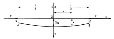
Fig. 1. Exzentrisch belasteter Stab.
