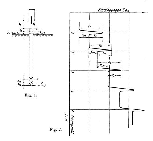
steigt die Pfahlkraft fortschreitend an, und damit nimmt auch die elastische Verformung nach der Gleichung (2) ständig zu. Nach einer gewissen Grenze wird die bleibende Eindringung des Pfahls praktisch Null  $(e_m \to 0)$ , womit die gesamte Rammarbeit in elastische Verformung umgewandelt wird. Damit erreichen auch die Pfahlkraft P und die in dem Pfahlschaft entstehenden Spannungen ihren Höchstwert, weil auch die elastischen Verformungen prak-
