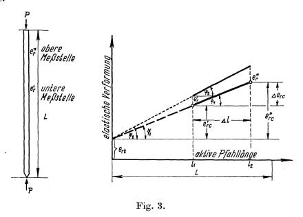
Für die Größe dieses Schnittpunktwertes ist es nicht gleichgültig, wie die Entfernungen  $l_1$  und  $l_2$  bestimmt werden. Für die hier angegebenen Berechnungen genügt es aber, wenn man mit dem Wert  $\Delta l = l_1 - l_2$  arbeitet, weil die im Pfahl auftretende Durchschnittsspannung durch die Gleichung
