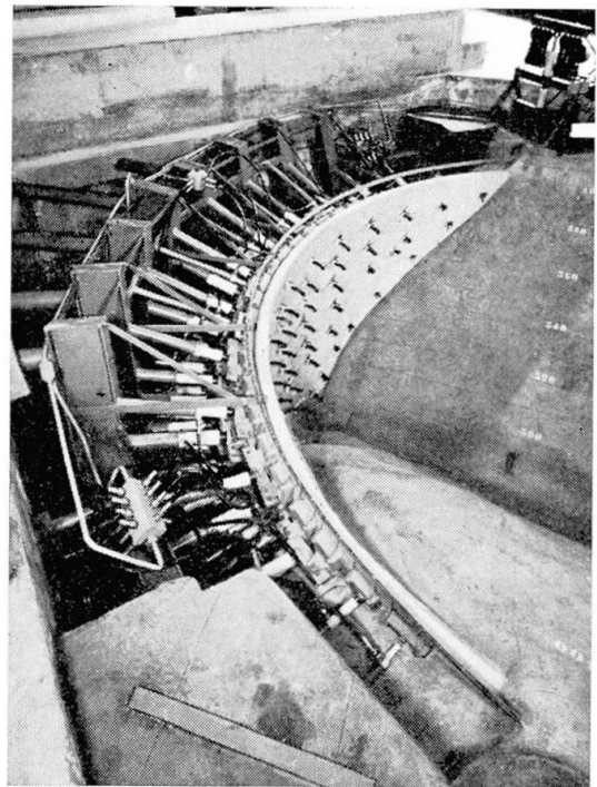
Fig. 14. Modèle du barrage de «Grancarevo»: appareillage type pour la charge hydrostatique (échelle 1 : 80).
