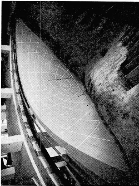
Fig. 11. Isostatiques relevées sur le parament aval du modèle d'un barrage-voûte.
