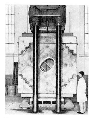
Fig. 13. Modèle d'un tunnel routier au pas de la «Cisa» (échelle 1 : 20) à double voie inférieure et supérieure.
