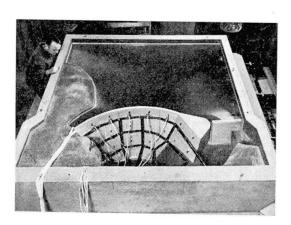
Fig. 1. Essais séismiques sur un modèle de barrage-voûte.
