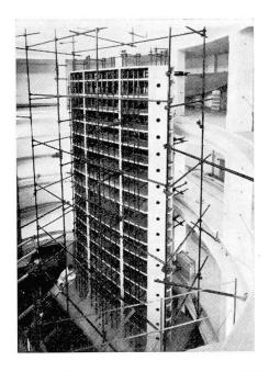
Fig. 9. Modèle 1 : 15 du gratte-ciel Pirelli à Milan, installé dans la tour expérimentale de l'ISMES.
