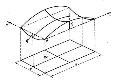
Fig. 1. Geometrische Elemente des hyperbolischen Sattelparaboloids
