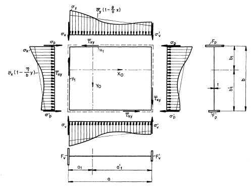
Fig. 1. Ausmaße und das Belastungsschema der versteiften Wand.
