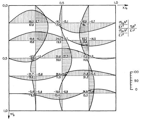
Fig. 4. Relative Biegespannungen auf der Wandoberfläche  $\frac{\sigma_{x_0}}{E} \left(\frac{b}{t}\right)^2$ ,  $\frac{\sigma_{y_0}}{E} \left(\frac{b}{t}\right)^2$ ,  $\frac{\tau_0}{E} \left(\frac{b}{t}\right)^2$ , die der Durchbiegungsfläche (Abb. 3) entsprechen.
