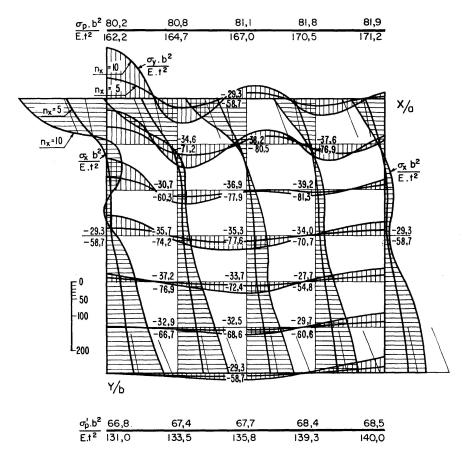
Fig. 5. Relative Spannung in der Mittelfläche einer quadratischen Wand  $\frac{\sigma_x}{E} \left(\frac{b}{t}\right)^2$ ,  $\frac{\sigma_y}{E} \left(\frac{b}{t}\right)^2$ ,  $\frac{\sigma_y}{E} \left(\frac{b}{t}\right)^2$  und die relative Spannung in den Gurten  $\frac{\sigma_p}{E} \left(\frac{b}{t}\right)^2$ ,  $\frac{\sigma_y'}{E} \left(\frac{b}{t}\right)^2$  bei einer 5- und 10-fachen Überschreitung der kritischen Last der Wand.
