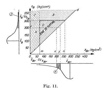
La probabilité partielle du risque de ruine vaut le produit de la probabilité qu'à  $X_{Br}$  d'être comprise entre x et y, représentée par l'aire hachurée 1, par la probabilité qu'à  $X_B$  d'être plus grand ou égal à z, représentée par l'aire hachurée 2.
