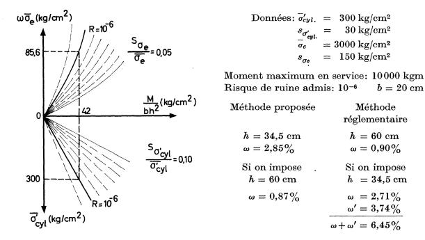
Fig. 14. Exemple de calcul d'une poutre.
