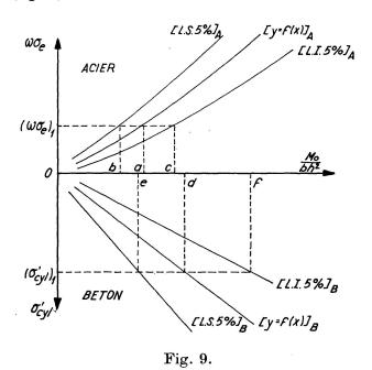
Pour une poutre dont on connaît les caractéristiques  $\omega \sigma_e$  et  $\sigma'_{cyl.}$ , la détermination du type de rupture le plus probable, du moment unitaire de rupture et de ses valeurs extrêmes au seuil de probabilité 5% n'offre aucune difficulté. Dans le cas de la figure 9, relative à une poutre de caractéristiques  $(\sigma_e)_1$  et  $(\sigma'_{cyl.})_1$ , la rupture la plus probable a lieu par insuffisance de l'acier car 0a est plus petit que 0d.
