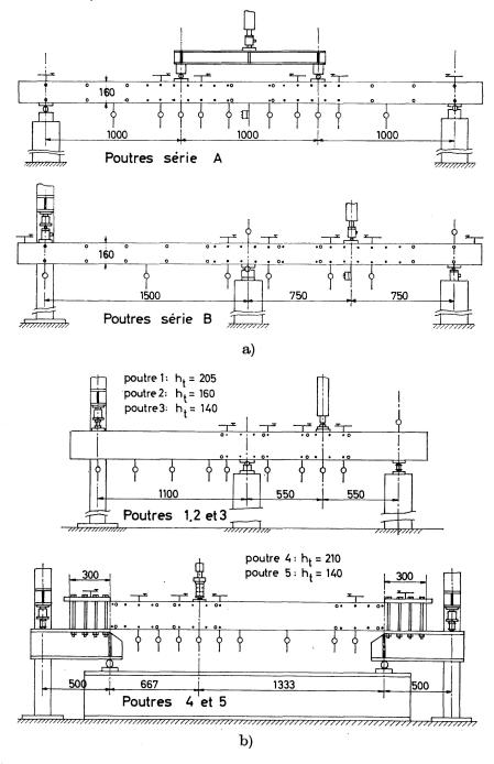
Fig. 9a et Fig. 9b. Dispositifs éxpérimentaux et appareils de mesure.
