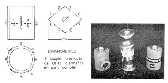
Fig. 10. Cellules dynamométriques.
