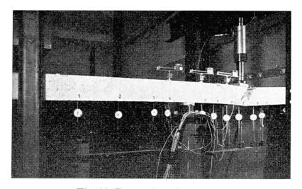
Fig. 22. Poutre 2 après rupture.
