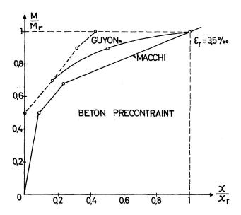
Fig. 3. Lois moment-courbures théoriques relatives au béton précontraint.
