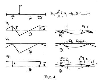
On peut le décomposer en deux diagrammes des moments  $M_0$  et  $M_{\overline{X}}$ , dus respectivement, dans le système de référence isostatique, aux charges extérieures et aux moments de rupture arbitraires  $\overline{X}_i$  appliqués aux lèvres des coupures.
