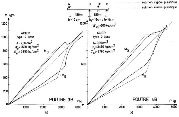
Fig. 16a et 16b. Evolutions (théorique et expérimentale) des moments dans les sections critiques des poutres 3 B et 4 B.
