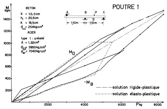
Fig. 18. Evolutions (théorique et expérimentale) des moments dans les sections critiques de la poutre 1.
