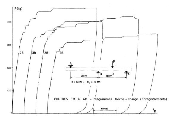
Fig. 17. Enregistrements flèches-charges (aciers à palier).
