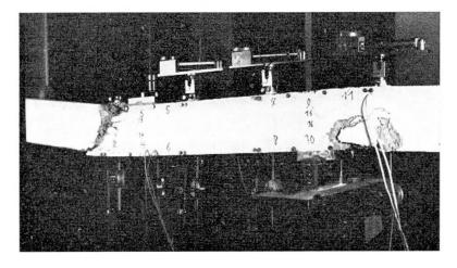
Fig. 24. Poutre 3 après rupture.
