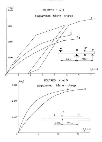
Fig. 19. Diagrammes flèche-charge (aciers écrouis).
