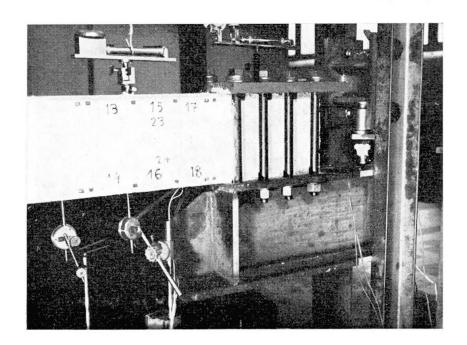
Fig. 26. Détail des encastrements élastiques.
