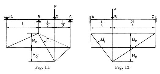
Fig. 11 et Fig. 12. Distribution des moments admises par la théorie des rotules plastiques.
