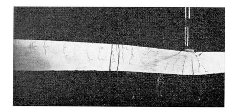
Fig. 20. Poutre 1 lors de la rupture.
