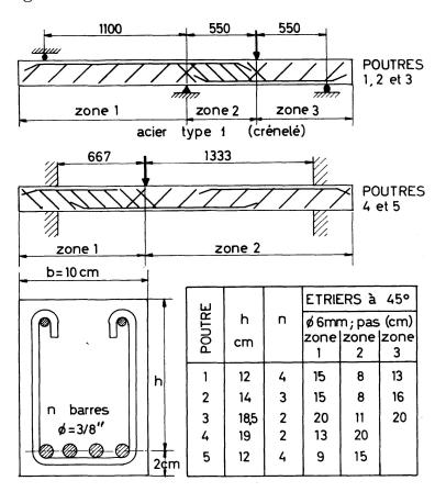
Fig. 8. Caractéristiques géométriques des poutres armées d'aciers écrouis. Poutres 1 à 5: données geométriques.
