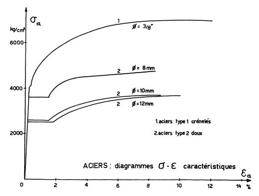
Fig. 6. Diagrammes tensions-dilatations caractéristiques des aciers employés.
