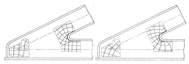
Fig. 21 a. Tracé des isostatiques à partir de l'observation des isoclines.
