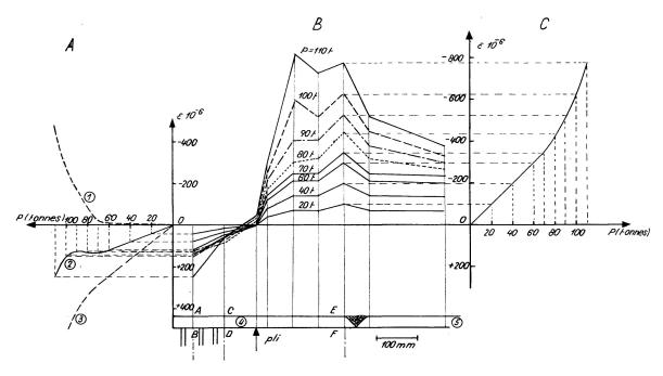
Fig. 35. About de pont nº 4 renforcé totalement raidi. Essai nº 12.
