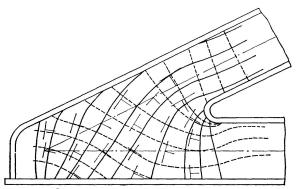
Fig. 7a. Réseau d'isostatiques. About de pont nº 1. Recuit. Essai nº 1 (voir tableau II).
