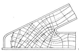
Fig. 7c. Réseau d'isostatiques. About de pont nº 1. Recuit. Essai nº 12 (voir tableau II).
