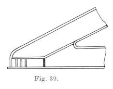
Ces pièces n'ont coincé à aucun moment, ce qui montre que dans le cas de l'expérience, des raidisseurs verticaux en cet endroit ne sont pas nécessaires, encore que leur présence ne nuirait en rien à la stabilité de l'about et n'entraînerait aucun danger dû au soudage.
