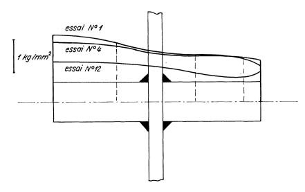
Fig. 26. Répartition des tensions longitudinales moyennes dans les raidisseurs. About de pont n° 3 partiellement raidi. (P = 20 tonnes).
