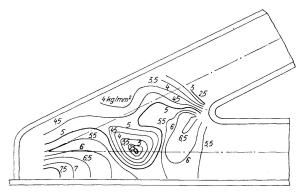
Fig. 8e. Réseau d'isochromatiques (P=20 tonnes). About de pont n° 2. Non recuit. Essai n° 4 (voir tableau II).
