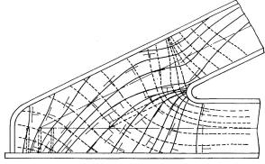
Fig. 22b. Réseau d'isostatiques. About de pont nº 3 partiellement raidi. Essai nº 4 (voir tableau II).
