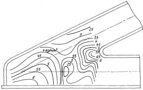
Fig. 8d. Réseau d'isochromatiques (P=20 tonnes). About de pont n° 2. Non recuit. Essai n° 1 (voir tableau II).
