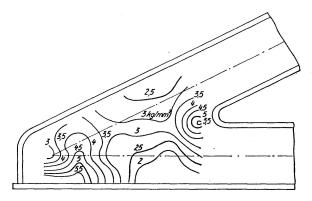
Fig. 8a. Réseau d'isochromatiques (P=20 tonnes). About de pont no 1. Recuit. Essai no 1 (voir tableau II).
