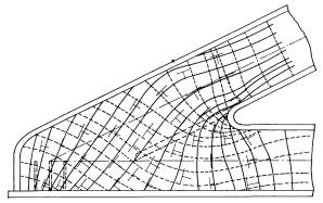
Fig. 22a. Réseau d'isostatiques. About de pont nº 3 partiellement raidi. Essai nº 1 (voir tableau II).
