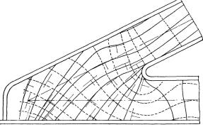
Fig. 7f. Réseau d'isostatiques. About de pont nº 2. Non recuit. Essai nº 12 (voir tableau II).
