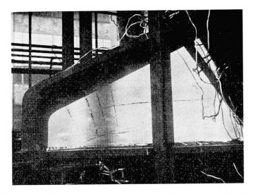
Fig. 11a. About de pont recuit. Ecaillage pour  $P=60\ \mathrm{t.}$
