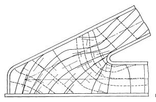
Fig. 7e. Réseau d'isostatiques. About de pont nº 2. Non recuit. Essai nº 4 (voir tableau II).
