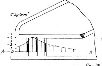
dans les raidisseurs verticaux placés sur le dos de l'âme dans l'âme
