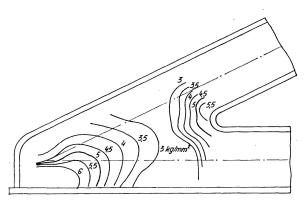
Fig. 8c. Réseau d'isochromatiques (P=20 tonnes). About de pont n° 1. Recuit. Essai n° 12 (voir tableau II).
