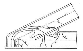
Fig. 23c. Réseau d'isochromatiques (P=20 tonnes). About de pont n° 3 partiellement raidi. Essai n° 12 (voir tableau II).
