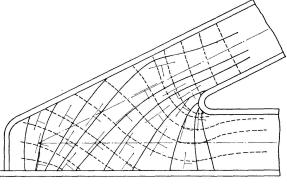
Fig. 7d. Réseau d'isostatiques. About de pont nº 2. Non recuit. Essai nº 1 (voir tableau II).
