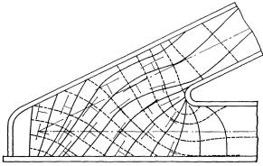
Fig. 7b. Réseau d'isostatiques. About de pont nº 1. Recuit. Essai nº 4 (voir tableau II).
