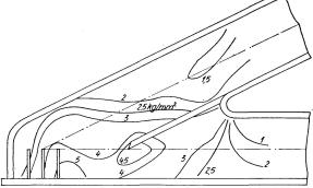
Fig. 23b. Réseau d'isochromatiques (P=20 tonnes). About de pont n° 3 partiellement raidi. Essai n° 4 (voir tableau II).
