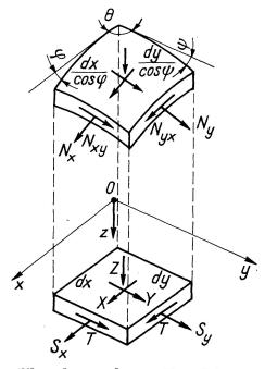
Fig. 2. Equilibre de membrane d'un élément de coque.
