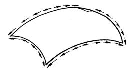
Fig. 3. Déchargement de la coque, le long des tympans, par des efforts tangentiels.
