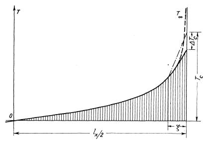
Fig. 7. Raccordement des efforts tangentiels au coin.
