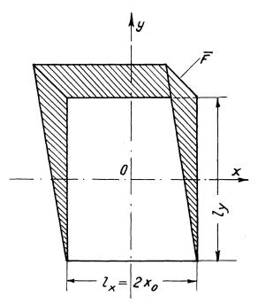
Fig. 4. Variation de la fonction de contrainte F sur le contour, dans le cas d'un seul plan de symétrie de l'état de contrainte.
