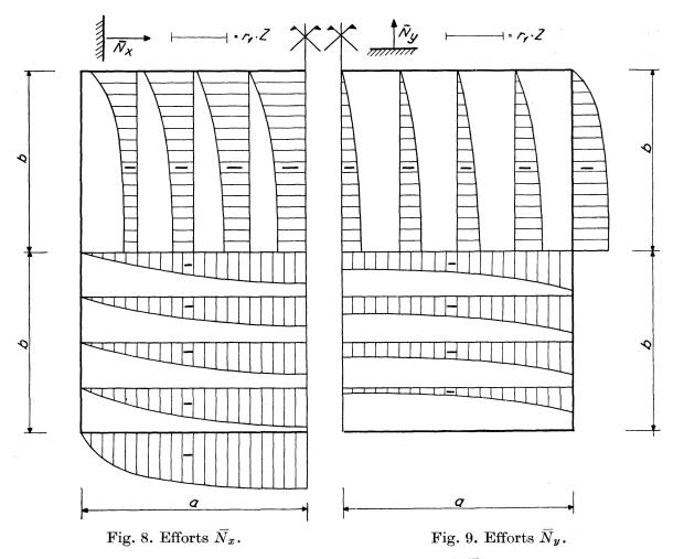
Pour déterminer les cisaillements  $T=\overline{N}_{xy}=-\frac{\partial^2 F}{\partial x \partial y}$ , on procède comme indiqué plus haut, c'est-à-dire on calcule d'abord les dérivées premières, par exemple  $\frac{\partial F}{\partial x}$ , à l'aide du tableau II (ou directement à partir des relations 14, avec les ordonnées F et les dérivées secondes évaluées précédemment).
