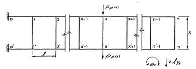
Fig. 1a. Vierendeel Truss.
