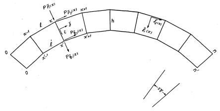
Fig. 5. Circular Vierendeel Truss.
