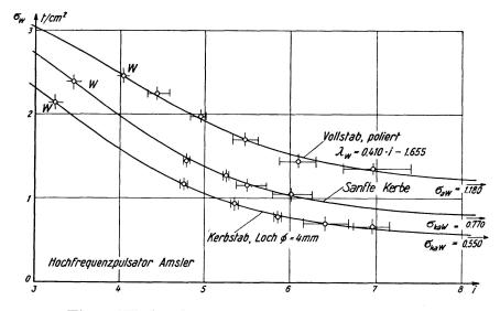
Fig. 5. Wechselfestigkeit der Legierung Z (AIAG).
