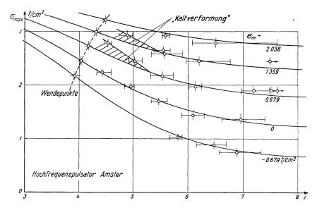
Fig. 6. Ermüdungsfestigkeit der Legierung Z (AIAG), Vollstab poliert.
