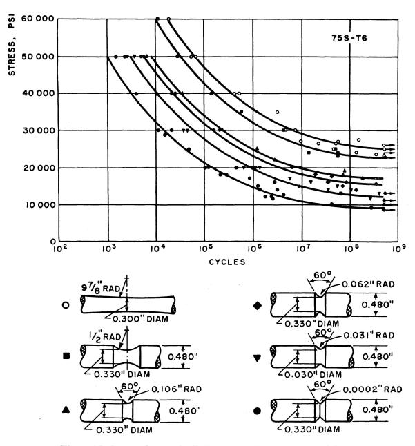
Fig. 3. Kerbversuche von R. L. Templin, Biegewechselfestigkeit.
