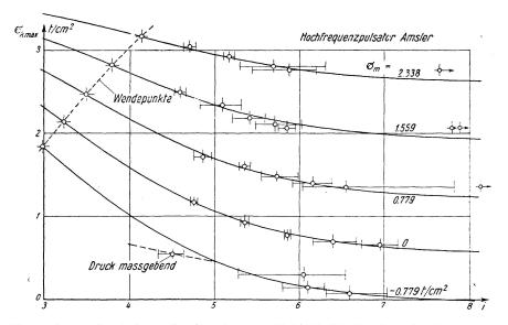
Fig. 7. Ermüdungsfestigkeit der Legierung Z (AIAG), Lochstab, Loch  $\emptyset = 4$  mm.
