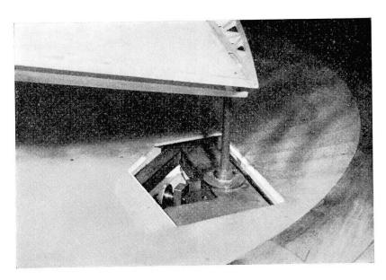
Fig. 10. Axes de rotation. Le couvercle Z=0 est enlevé. On voit une vis avec bouton molleté constituant l'un des paliers de l'un des axes horizontaux servant à la mesure. L'extrémité supérieure de l'un des axes verticaux est visible sur le bloc palier.
