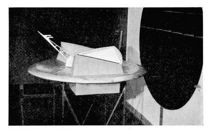
Fig. 3. Montage en soufflerie. Le vent est normal à la façade sud. Une maquette a été montée sous le plateau-sol; elle a pour effet de maintenir le courant parallèle au sol en réalisant la symétrie des résistances aérodynamiques.
