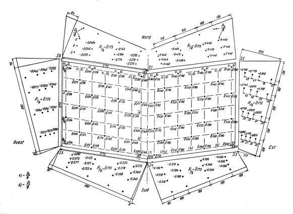
Fig. 17. Exposition de Bruxelles. Pavillon de la France. Les pressions sur la toiture et les façades. Configuration : Bâtiment avec toiture et signal. 4 façades. Direction du vent est. Par vent ouest les pressions sont disposées symétriquement.
