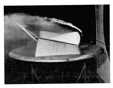
Fig. 18. Visualisation du courant. Maquette avec façades, vent sud. Prise de vue instantannée. La turbulence du courant est très forte. On distingue un courant inversé en arrière de la façade nord.
