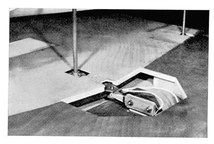
Fig. 11. Jauge électrostatique. Le couvercle étant enlevé, on voit le montage du dynamomètre mesurant l'une des composantes de l'effort vertical sur les fondations. Le bâti repose sur la tête de la jauge.
