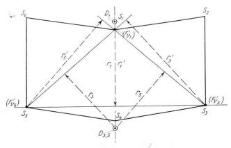
Fig. 9. Forces composantes verticales en  $S_1 S_3$  et  $S_5$ . Axes de mesure des moments:  $S_1 S_3 - S_3 S_5 - S_1 S_5$ . Emplacement des dynamomètres:  $D_1$  et  $D_{3,5}$ .
