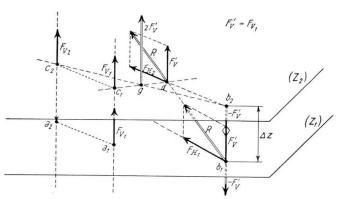
Fig. 13. Transport des forces résultantes.  $F_{H1}$   $F_{V1}$   $(Z_1)$  dans le plan  $(Z_2)$   $F_{H2}$   $F_{V2}$ . Déplacement des lignes d'action:  $a_1$   $a_2$   $b_1$   $b_2 = \Delta Z$   $F_{V2} = F_{V1}$   $F_{H2} = F_{H1}$ .
