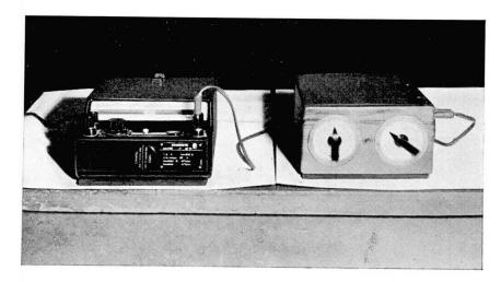
Fig. 12. Enregistrement des mesures. L'effort exercé sur la jauge produit une déviation du spot lumineux visible sur la boîte de mesure à gauche de la photo. Il est ramené au zéro par le jeu des manettes visibles à droite. On lit l'écart angulaire.
