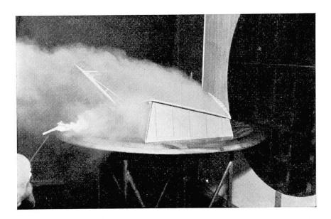
Fig. 19. Visualisation du courant. Emission nord. Le cliché est inverse du précédent. Le courant est visualisé à l'intérieur de la zone de sillage; il remonte le vent jusqu'à la poutre de rive de la façade sud.
