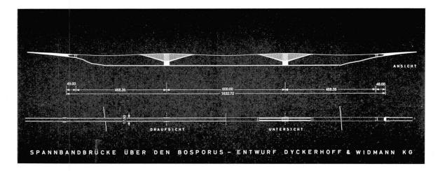
Fig. 22. Pont sur le Bosphore d'après M. Finsterwalder.
