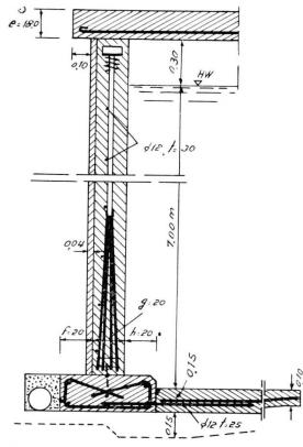
Fig. 36. Détail montrant le joint qui sépare la paroi verticale du radier.
