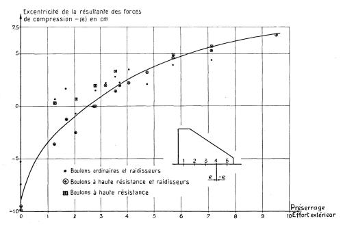
Fig. 14. Variation de l'excentricité de la résultante des forces de compression en fonction du rapport préserrage sur effort extérieur.
