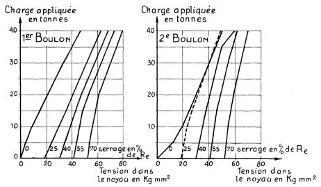
Fig. 11. Tension totale dans les premier et deuxième boulons en fonction du serrage initial et de l'effort extérieur pour les consoles raidies.
