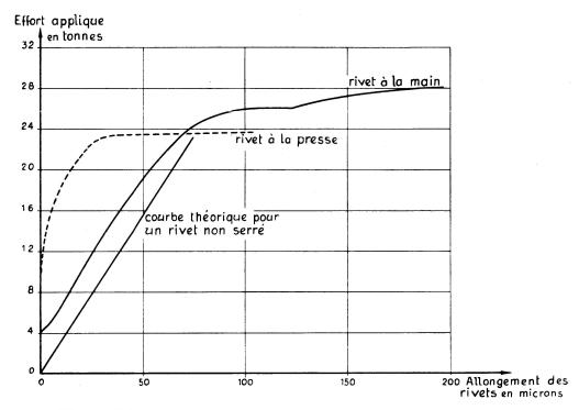
Fig. 4. Diagrammes efforts-allongements obtenus sur des rivets.
