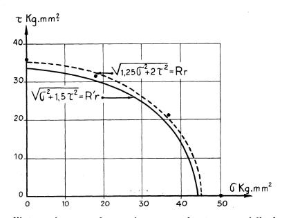
Fig. 7. Courbe d'interaction entre les tensions normale et tangentielle de rupture dans des rivets soumis à un essai statique.
