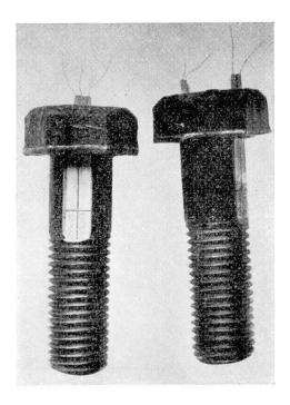
Fig. 6. Boulon muni de jauges ohmiques.
