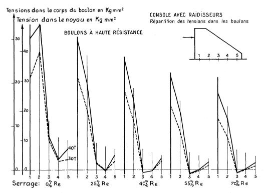
Fig. 12. Tensions dans les différents boulons due à l'effort extérieur.
