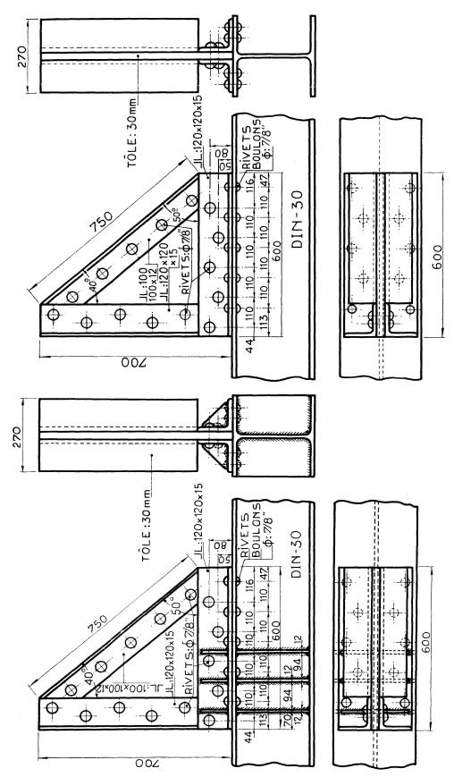
Fig. 9. Plan des consoles raidies et non raidies.
