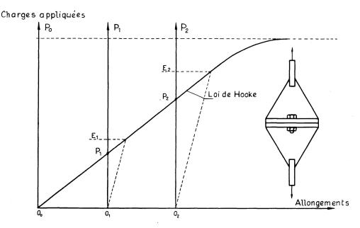
Fig. 3. Diagramme charges-allongements d'un assemblage à boulons tendus préserrés.
