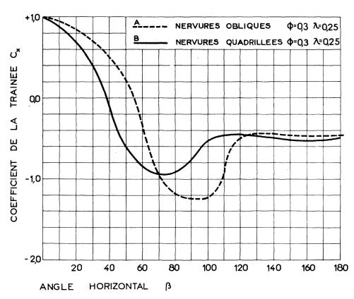
Fig. 4. Les courbes  $C_x-\beta$  dans le cas des nervures obliques suivant les génératrices rectilignes.
