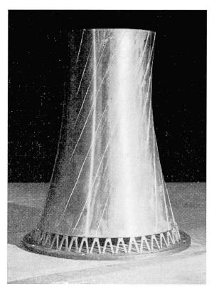
Fig. 6. Modèle avec les nervures obliques dans le sens d'une seule famille des génératrices rectilignes, dont l'épaisseur est de l'ordre de  $^1/_3$  de l'épaisseur de la coque, soit 0,3 mm.
