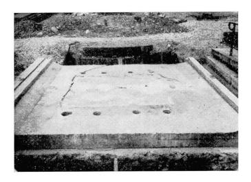
Fig. 10. Tablier après essai, vu de dessus.
