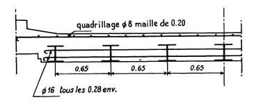
Fig. 1a. Détail des armatures. Tablier d'essai 7 HE 18
