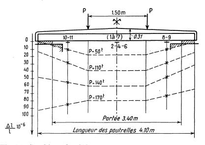
Fig. 15. Graphique des déformations moyennes des poutrelles.
