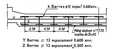
Fig. 1b. Détail des armatures. Tablier type 11 HN 18
