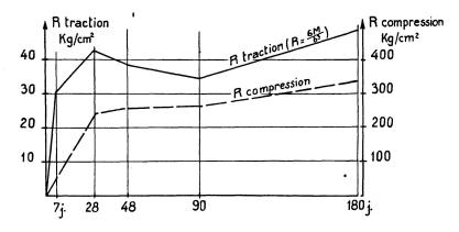
Fig. 3. Caractéristiques de résistance du béton du tablier
