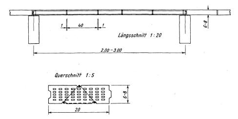
Fig. 1. Bewehrte Schwammziegelplatte.
