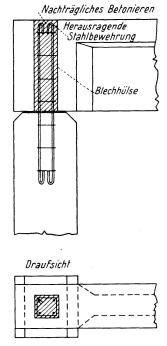
Fig. 9. Gelenkiger Anschluß der Binder an die Säule.
