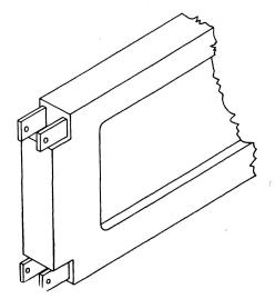
Fig. 14. Zugverbindung des Balkens.
