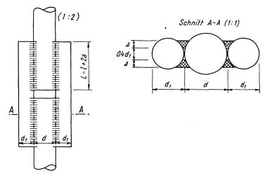
Fig. 18. Stoßen der Stahleinlagen durch Schweißen.
