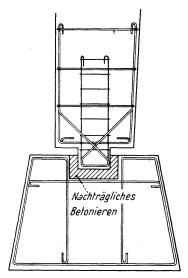
Fig. 10. Gelenkiger Anschluß des Rahmenstieles an das Fundament.
