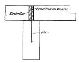
Fig. 8. Aufliegen der Pfette auf dem Balken-Hauptträger.
