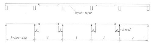
Fig. 2. Stahlbeton-Gelenkspfette.
