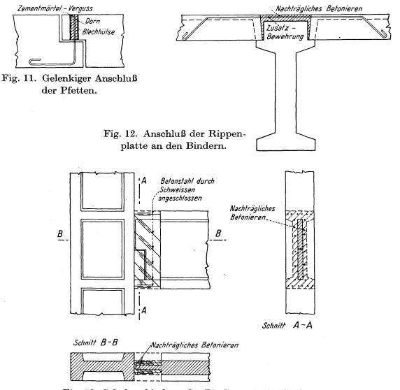
Fig. 13. Schubverbindung des Binders mit der Säule.
