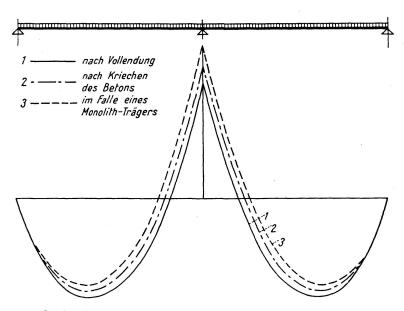
Fig. 19. Momentenfläche bei dem aus vorgefertigten Einfeldbalken zusammengebauten Durchlaufträger.
