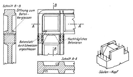
Fig. 15. Ecksteife Verbindung des Riegels mit der Säule.
