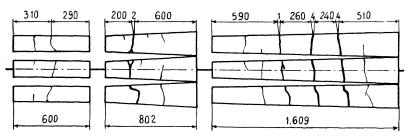
3e essai: Eprouvette n° 2 développée.
