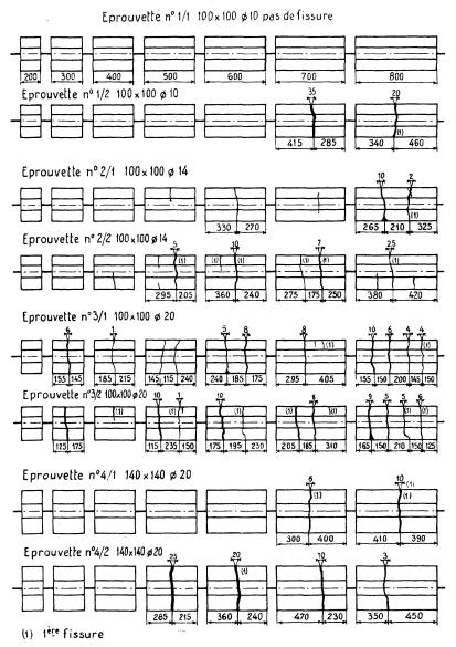
Fig. 4. Eprouvettes après fissuration finale (4e essai).
