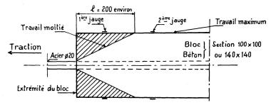
Fig. 7. Schéma de la répartition des efforts sur les têtes des manchons.
