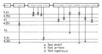
Fig. 1a. Apparition des fissures (2e essai: Eprouvette n° 2).
