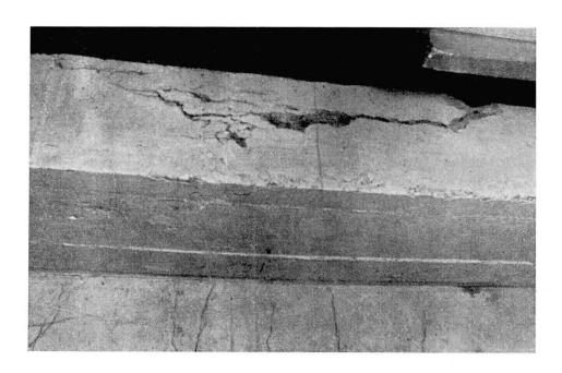
Fig. 6. Poutre rompue. Vue de la compression.
