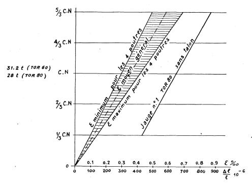
Fig. 4. Accourcissements du béton comprimé.
