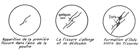
Fig. 5. Formation schématique des fissures dans les poutres armées d'acier TOR 60 et 80.
