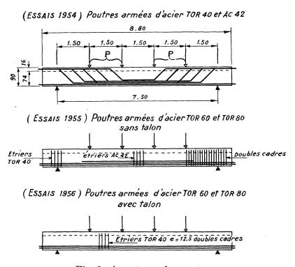
Fig. 1. Armatures des poutres.
