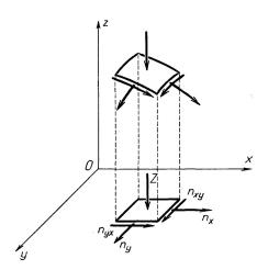
Fig. 2. Die Komponenten der Innenkräfte und ihre Grundrißprojektionen.
