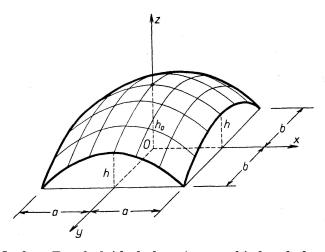
Fig. 9. Abgeflachte Paraboloidschale mit verschieden hohen Randbögen.
