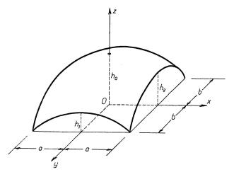
Fig. 1. Kappenschale über rechteckigem Grundriß.
