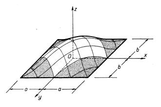
Fig. 8. Diagrammfläche der Spannungsfunktion der zusammengesetzten Kappenschale.
