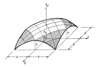
Fig. 7. Zusammengesetzte Kappenschale.
