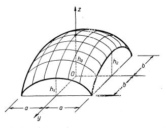
Fig. 5. Normale Translationsschale mit zykloidähnlichen Randbögen.
