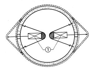
Fig. 1. Schéma de frettage adopté à Marèges. 1 Vérins.
