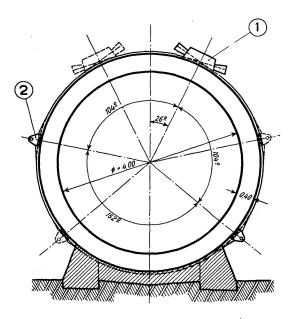
Fig. 6. Schéma de frettage du deuxième essai de Bort. 1 Traction directe. 2 Traction par écartement du câble.
