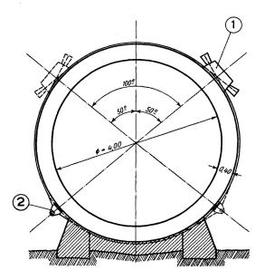
Fig. 2. Schéma de frettage du premier essai de Bort. 1 Traction directe. 2 Traction par écartement du cable.
