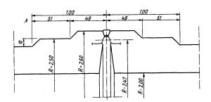
Fig. 9. Joint entre deux éléments de conduite.
