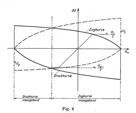
für  $\xi = (\pm)\infty$ . Die Kurven  $\mu$  nach Gleichung (3) verlaufen somit auch für negative Werte  $\xi$  vernünftig. Die Grenze des Gültigkeitsbereiches bei abnehmendem  $\xi$  ( $\sigma_m < 0$ ) ist offenbar durch die "Druckkurve" von  $\mu$  gegeben. Ohne hier weiter auf die besonderen Verhältnisse bei größeren Druckspannungen  $\sigma_m$  eintreten zu wollen, sei doch mit Figur 4 schematisch auf diese Grenze der Gültigkeit
