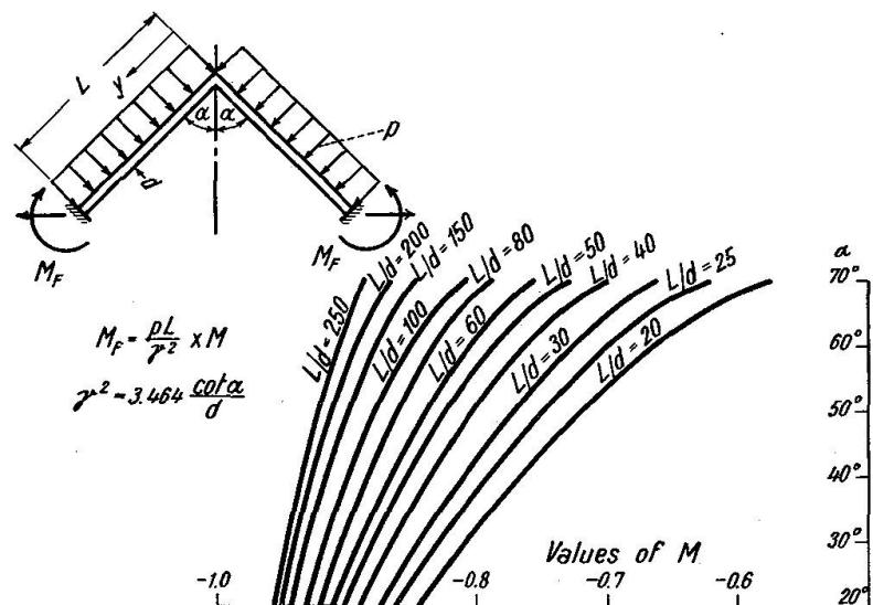
Fig. 10a. Fixed End Moment — Normal Load
