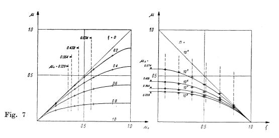
aus dem Wert  $\Delta \sigma_{max}$  bestimmbar. Da die Kurventafeln unabhängig von den Versuchswerten bestimmt worden sind, darf wohl der Schluß gezogen werden, daß sie, über den untersuchten Fall der Versuchswerte von Noral 26 SWP hinaus, allgemeine Gültigkeit besitzen.
