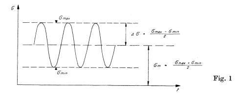
Bei der Dauerfestigkeit stehen die in Fig. 1 bezeichneten Spannungswerte im Spiel. Als Konstruktionsgrundlage ist es zweckmäßig und üblich, die Werte  $\sigma_{max}$  und  $\sigma_{min}$  zu verwenden; dagegen zeigt es sich, daß es für die Versuchsauswertung zweckmäßiger ist, von den Werten
