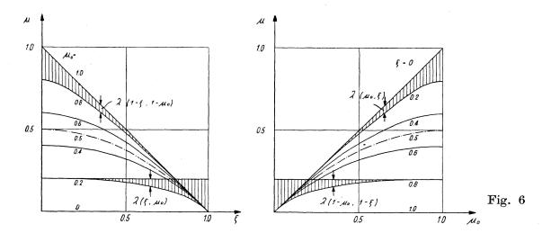
der Kurven  $\mu$  schließen. Für  $\mu_0 = 0.5$ , bzw.  $\xi = 0.5$  genügt die (in Fig. 6 gestrichelt eingetragene) quadratische Parabel sowohl den Randbedingungen wie auch den Symmetrie- und Reziprozitätsbedingungen der Kurven  $\mu$ .
