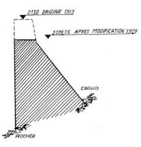
Fig. 1. Profil du barrage du Lac Carré
