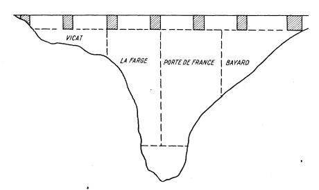
Fig. 5. Barrage du Chambon. Repartition des ciments sur le parement aval
