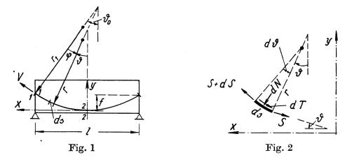
Die Reibungskraft für das Element  $ds = r \cdot d\vartheta$  wird
