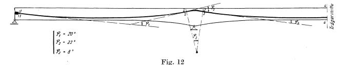
b) Zweites Beispiel. Für einen Durchlaufträger, von dem in Fig. 12 nur die Hälfte dargestellt ist, ist die Verminderung der Vorspannkraft durch die Reibung für die Querschnitte 2, 3 und 4 zu ermitteln. Das Zugglied wird gleichzeitig von den beiden Enden vorgespannt.
