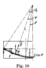
Unter Vernachlässigung der Reibung ergibt sich für einen Spannstab mit kreisförmiger Achse (Fig. 10) eine konstante Normalpressung von
