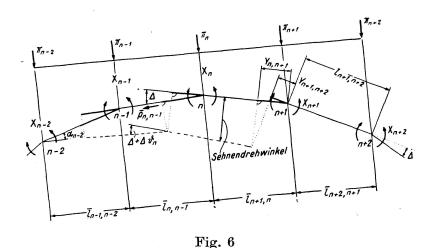
diese wählen wir jeweils das zugehörige Gelenkwerk als Grundsystem und bringen an diesem, neben den gegebenen Lasten, die als Unbekannte gewählten Knotenmomente  $X_n$  ebenfalls als äußere Kräfte an. Diese  $X_n$  ersetzen wir durch die, in den Kanten n angreifenden, zueinander parallelen Linienlasten
