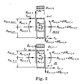
Differentiert man dies bei konstanten J und F einmal nach x, setzt Gl. (2) und (3) sowie Gl. (2') und (3') ein, so folgen die Beziehungen
