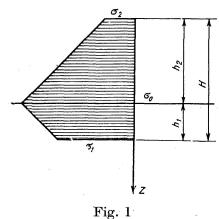
Die Spannungsverteilung nach Gl. (1) längs der Z-Richtung ist in Fig. I dargestellt und an jeder Stelle der Platte dieselbe. Auch längs der Ränder  $x=\pm a$  und  $y=\pm b$  herrscht gleiche Spannungsverteilung. Die Spannungen besitzen sowohl eine Resultierende N, als auch ein Moment M. Für erstere ergibt sich
