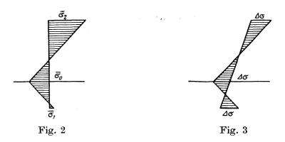
Diese Lösung stellt allerdings nur eine Näherung vor, da sich nach der Theorie der Platten ein an den Rändern angreifendes Moment linear über die ganze Plattendicke H und nicht so, wie in Fig. 2 dargestellt, verteilt. Aber die Spannungsdifferenzen zwischen diesen beiden Spannungsverteilungen, die in Fig. 3 dargestellt sind, haben weder ein Moment noch eine Resultierende, und es kann daher nach dem Prinzip von St. Venant ihr Einfluß bereits in einiger Entfernung vom Rande vernachlässigt werden.
