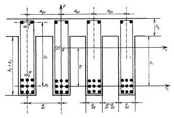
Fig. 4. Coupe transversale d'une plaque nervurée
