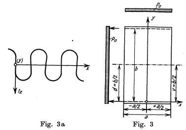
Fig. 3. Charge uniformément répartie sur toute la plaque Fig. 3a. Coupe transversale d'une poutrelle en tôle ondulée
