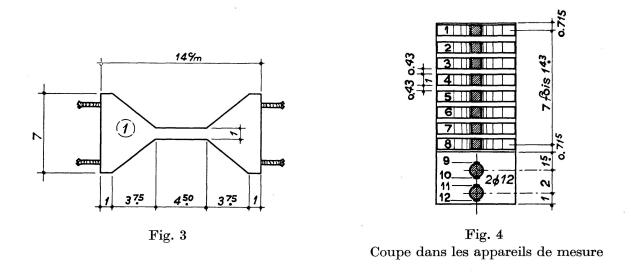
que la surface du béton intéressée par chacun d'eux est de:  $1.43 \times 7 = 10$  cm² (Nos 1 à 8, fig. 4). De petits scellements sont en outre fixés aux extrémités de chaque pièce, afin de permettre la transmission des efforts de traction. De plus, des jauges de traction sont placées le long des génératrices supérieures et inférieures de chacune des barres d'armatures (Nos 9 à 12).
