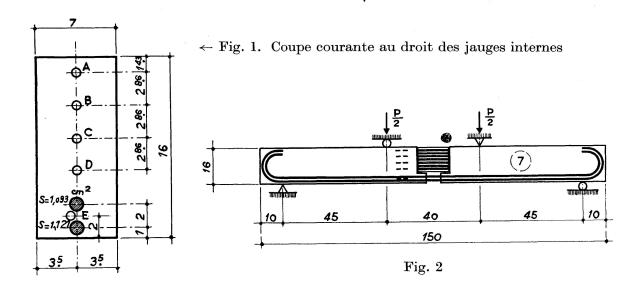
La partie médiane de ces éléments a 1 cm<sup>2</sup> de section et 45 mm de longueur; c'est sur cette partie que l'on effectue les mesures de contrainte à l'aide des jauges à fil résistant qui y sont collées. Ces dynamomètres sont empilés les uns sur les autres, avec un espacement de 1,43 cm d'axe en axe, de telle sorte
