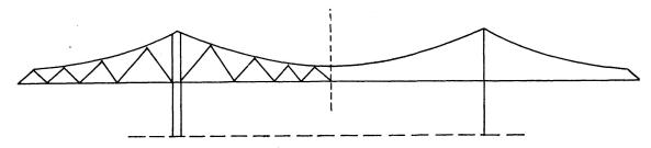
Fig. 6. Type de poutre continue suspendue à treillis, avec câble et barres en fil à haute contrainte maintenus en extension
