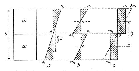
Fig. 8. Poutre rectangulaire avec réglage des contraintes
