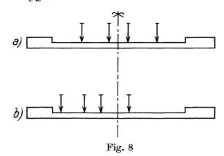
est donc encore égal au quotient  $M_x/M_x^0$ , où  $M_x$  est le moment fléchissant réel dans la section x de la poutre et où  $M_x^0$  représente le moment moyen qui naîtrait dans les poutres du pont, si elles fléchissaient toutes identiquement.
