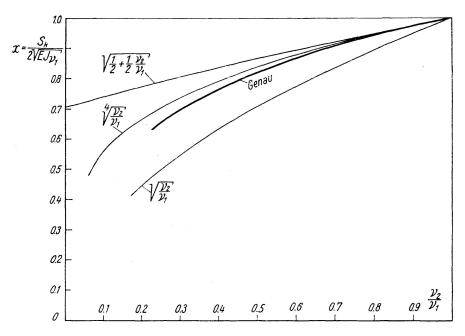
Abb. 14. Gurtknicklast  $S_k$  in Abhängigkeit des Verhältnisses  $\nu_2/\nu_1$  der Stärke der seitlichen Stützungen
