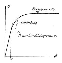
${\bf Abb.~3} \\ {\bf Spannung dehnung s diagramm}$
