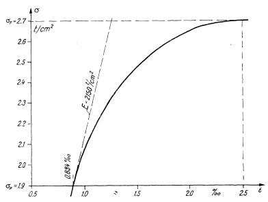
Abb. 5. Spannungdehnungsdiagramm für St. 37
