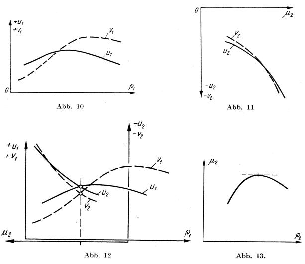
Abb. 10, 11, 12 und 13. Zur Lösung der Knickbedingung mit der Nebenbedingung  $\mu_2\!=\!\max$  für gegebenes  $\mu_1$
