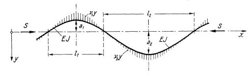
Abb. 15. Zur Bestimmung der Knicklast mit Hilfe der Energiemethode
