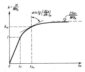
Abb. 4. Verhältnis k des Biegungsmomentes zum Biegungsmoment beim Erreichen von  $\sigma_P$  in Funktion der Randdehnung  $\epsilon_R$
