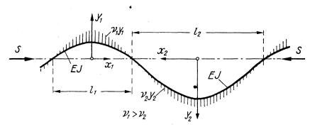
Abb. 9. Knickung eines je nach der Knickrichtung verschieden stark gebetteten Druckstabes (für  $\nu_2/\nu_1=0,263)$
