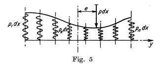
Dans ces conditions, la force extérieure  $p\,dx$  appliquée à une entretoise élémentaire de largeur dx est équilibrée par les réactions élémentaires  $p_k\,dx$  des longerons (fig. 5). On a donc
