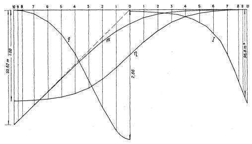
Fig. 6. Diagramme des moments d'inertie I. Lignes d'influence des réactions X, Y, µ
