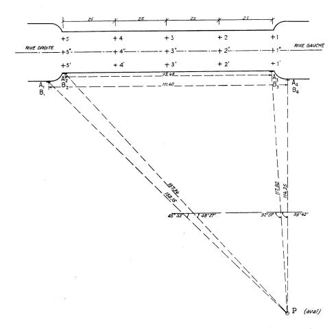
Fig. 10. Plan schématique. On observe les points nivelés et la position de la station en aval
