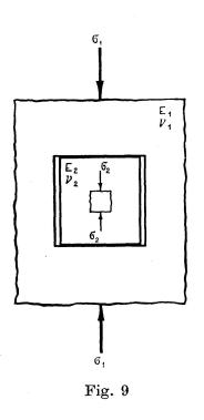
Considérons un cylindre de diamètre sensiblement égal à sa hauteur, constitué d'un matériau de module d'élasticité  $E_2$  et de coefficient de Poisson  $\nu_2$ . Supposons qu'il soit inclus dans un solide de constantes élastiques  $E_1$  et  $\nu_1$ , et de manière telle que l'adhérence entre sa surface latérale et le solide soit evitée, la liaison du cylindre au solide ne se faisant que par ses bases (fig. 9).
