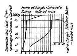
Fig. 4. Ouverture d'une fissure centrale sous la charge. Largeur des fissures en  $^{1}/_{100}$  mm — Öffnung eines mittleren Risses unter der Belastung. Rißbreite in  $^{1}/_{100}$  mm — Opening of a central crack under load. Breadth of cracks in  $^{1}/_{100}$  mm.
