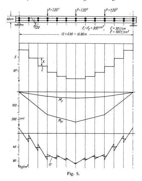
Damit eine Näherungsberechnung den dem zusammengesetzten Balken eigentümlichen Verlauf der Randspannungen  $\sigma$  einigermaßen zutreffend wiedergeben kann, müssen wir die Randspannung  $\sigma$  in zwei Anteile zerlegen (Fig. 7),
