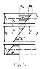
Diese vereinfachte Gleichung (6) kann nun auch direkt und einfacher gefunden werden, indem wir die Elastizitätsbedingung gleicher Durchbiegung der Einzelbalken (näherungsweise) dadurch ausdrücken, daß je in Feldmitte die Normalspannungsbilder über die drei Einzelbalken gleiche Neigung besitzen sollen (Fig. 4):
