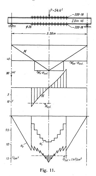
Die genauere Untersuchung dieses Beispiels, dessen Bemessung nach den üblichen Regeln der Stahlbaupraxis durchaus in Ordnung ist, zeigt nun, daß sowohl das erste Nietpaar mit rd. 11 % als auch das Grundprofil in Trägermitte mit rd. 17 % überbeansprucht sind, während das aufgenietete Lamellenpaar nur mit etwa 65 %, also ungenügend ausgenützt ist. Bei einer Vergrößerung des angenommenen Nietwiderstandes C wäre die Überlastung des ersten Nietpaares noch größer geworden, während umgekehrt bei einer
