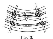
Höhe der Dübelmitte gemessen, des oberen Randbalkens und mit  $\Delta d_i$ " die Längenänderung der ideellen oberen Randfaser des Mittelbalkens, sowie mit  $\varepsilon_{i-1}$  und  $\varepsilon_i$  die Verformungen der Dübel  $D_{i-1}$  und  $D_i$ , so ist nach Fig. 3
