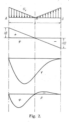
b) Gleichmäßiger Druck, Längsränder eingespannt,  $\beta = 1.5$ :
