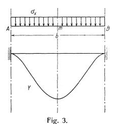
Fig. 3 zeigt die Form der Ausbiegungskurse Y; die scharfe Krümmung an der Einspannstelle läßt auf große Einspannmomente und damit auf große Veränderlichkeit der Kurven Y" und damit Y"" schließen, so daß die Notwendigkeit einer verhältnismäßig engen Feldteilung zur Erreichung einer großen Genauigkeit verständlich ist.
