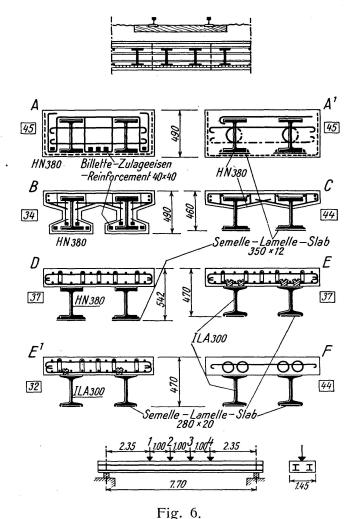
Tabliers d'essai. - Coupes transversales — Versuchsfahrbahnen. - Querschnitte — Experimental slabs. - Cross-sections.
