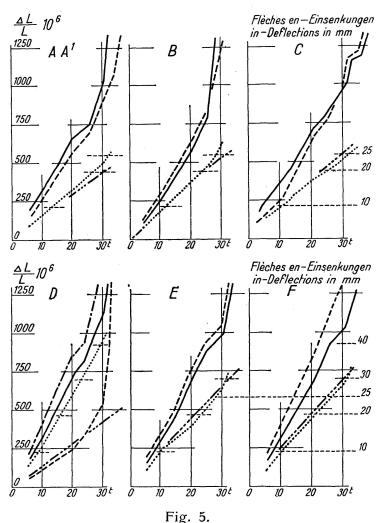
Relevé des mesures faites sur les tabliers d'essai — Zusammenstellung der Messungen an Versuchsträgern — Summary of measurements made on experimental roadway slabs.
