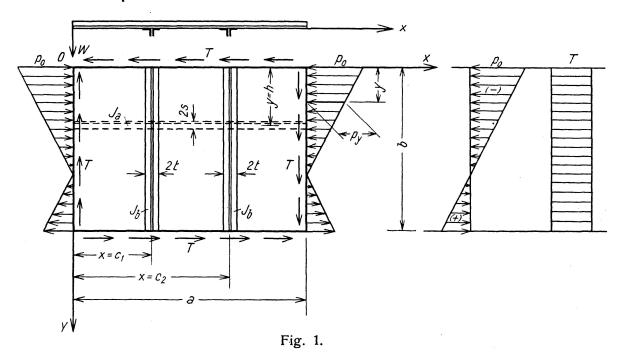
et la plaque est assurée par rivetage ou soudage de façon que les raidisseurs participent aux déformations de la plaque lors du flambage. Dans cette étude, on fera les suppositions suivantes:
