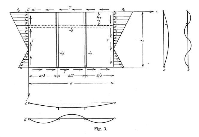
Dans la suite, et en nous basant sur des considérations pratiques, nous placerons le raidisseur longitudinal à la distance h/4 du bord supérieur et les raidisseurs transversaux aux distances a/3 et 2/3a des bords latéraux.
