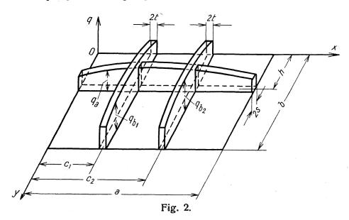
Soit  $J_a$  le moment d'inertie du raidisseur longitudinal et 2s sa largeur,  $J_b$  celui d'un raidisseur transversal dont la largeur est 2t (voir fig. 1). La plaque et le raidisseur se déformant de la même manière lors du
