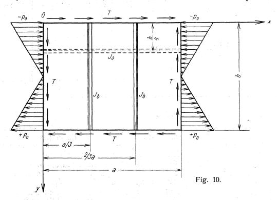
La figure 10 représente le cas d'une plaque mince sollicitée dans son plan simultanément à la flexion et au cisaillement et renforcée comme indiqué plus haut. On obtient le déterminant du système d'après l'expression générale du déterminant donné par le tableau I en y faisant  $\varphi=2$ .
