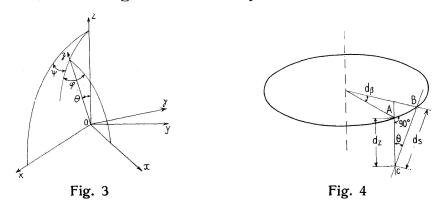
On peut exprimer k, k' et  $\tau$  en fonction des trois angles d'EULER  $\Theta$ ,  $\varphi$ ,  $\psi$  (fig. 3) utilisés dans la théorie du mouvement d'un corps solide. On trouve (Réf. 1, p. 153; Réf. 2, p. 386):
