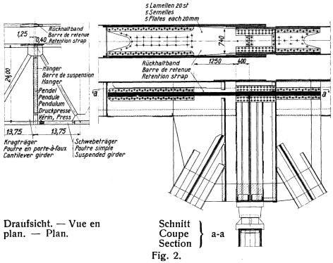
Schnitt durch den Obergurtknotenpunkt beim Gelenk der Mittelöffnung. Coupe du noeud de la membrure supérieure près de l'articulation de la travée médiane. Section near hinge through upper boom panel point.
