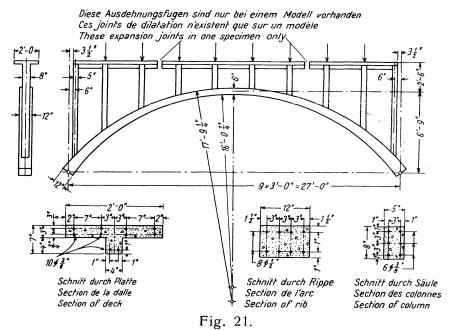
Einzelheiten von Bogen mit hochliegender Fahrbahn. Détails des arcs à tablier surélevé. Details of Span with High Deck.
