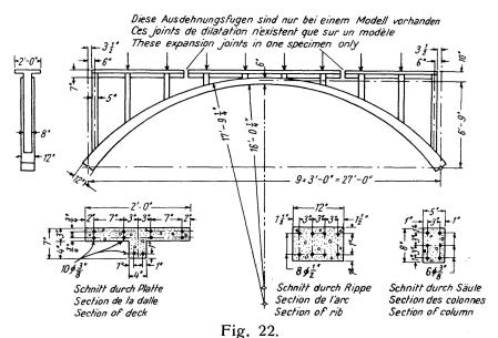
Einzelheiten von Bogen mit Fahrbahn auf Scheitel. Détails des arcs à tablier surbaissé. Details of Span with Low Deck.
