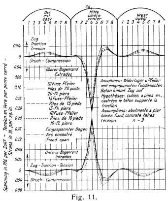
Einflußlinien der Spannungen in Lastpunkt C 4. Lignes d'influence des tensions au point C 4. Influence Lines for Stress at Load Point C 4.
