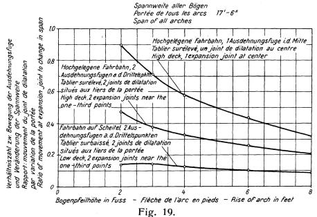
Beziehungen zwischen Bewegung der Ausdehnungsfuge und Pfeilhöhe des Bogens. Relation entre le déplacement des joints de dilatation et la flèche de l'arc. Relation Between Movement At Expansion Joint and Rise of Rib.
