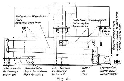
Apparat zur Messung von Auflagerkräften an Pfeilern. Appareil permettant de mesurer les réactions à la base des piles. Apparatus for Measuring Reactions at Pier Bases.
