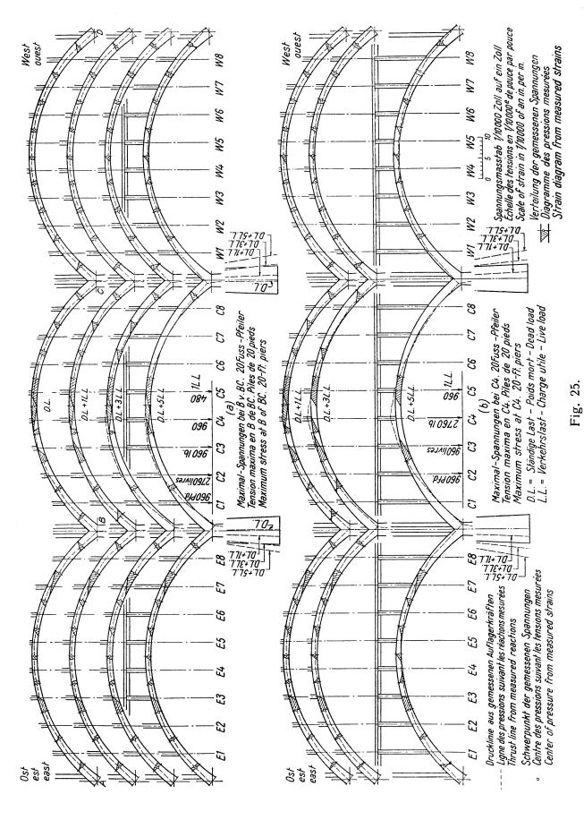
Drucklinien für Tragfähigkeitsversuch. Aufbau mit hochliegender Fahrbahn ohne Zwischenausdehnungsfugen, 20-Fuß Pfeiler. Ligne de pression déterminée par l'essai de résistance. Tablier surélevé sans joints de dilatation intermédiaires. Piles de 20 pieds. Thrust Line for Capacity Test. Structure with High Deck without Intermediate Expansion Joints. 20-Foot Piers.
