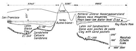
Fig. 4. San Francisco-Oakland Bay Bridge. Geologisches Profil — Profil géologique — Geological profile.
