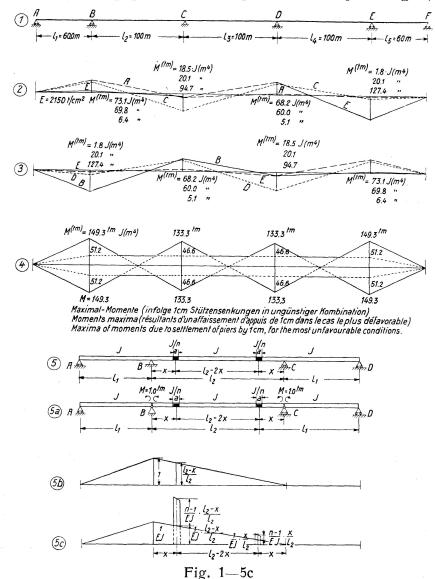
so kann man die so erhaltene Spannungslinie zur Charakterisierung (und im Falle von mehreren Trägersystemen zum Vergleich) der Empfindlichkeit des Trägers in bezug auf ungleichmäßige Stützensenkungen verwenden. (In diesem Beispiel wäre die Spannungslinie für vorausgesetzte konstante Querschnitte eine der Momentenlinie ähnlich verlaufende Linie.)
