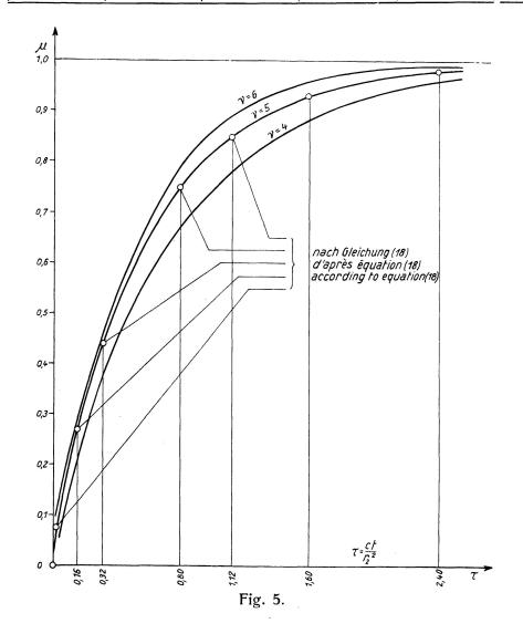
In Fig. 5 sind die Wasseraustrittskurven für  $\nu=4,5$  und 6 aufgetragen; die Übereinstimmung der Kurve für  $\nu=5$  mit den Ergebnissen der strengen Behandlung ist, wie man aus der Figur erkennt, eine sehr gute. Die größten Unterschiede zwischen der strengen und der angenäherten Berechnung betragen unter 6 % der Gesamtformänderung und liegen im Beginn der Kurve, wo der Verfestigungsgrad noch unter 10 % ist; bei  $\mu$ -Werten von rund 25 % ist der Fehler schon unter 2 % gesunken.
