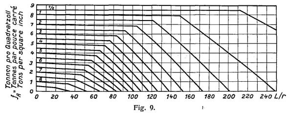
Zulässige Endspannung (zusammengesetzte Kurve). Contrainte finale admissible (courbes composées). Permissible end bending stress (composite curve).
