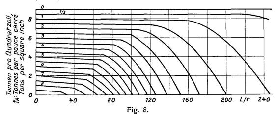
Zulässige Endspannung bei "Doppelkrümmung". Contrainte finale admissible pour une "courbure double". Permissible end bending stress with "double curvature".
