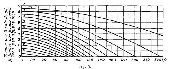
Zulässige Endspannung bei "einfacher Krümmung". Contrainte finale admissible pour une "courbure simple". Permissible end bending stress with "single curvature".
