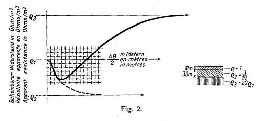
Inversement, si restant en une même station, on procède à une série de mesures en augmentant chaque fois la longueur de la ligne AB, les chiffres obtenus correspondent à des tranches de sol de plus en plus épaisses. C'est ce que l'on appelle "un sondage électrique".
