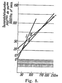
posées. Il s'agissait d'étudier un banc de calcaire recouvert d'une couche superficielle de marnes. L'étude sismique a fait apparaître un troisième terrain plus profond constitué par des dolomies.
